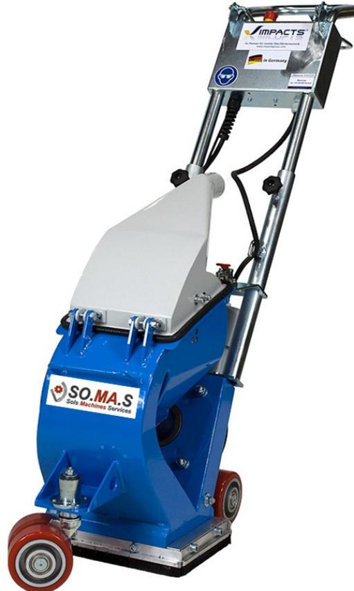
La grenailleuse S210E est dotée d'une largeur de travail de 210 mm lui permettant un résultat parfaitement homogène et un rendement de 45 m<sup>2</sup>/h environ.
